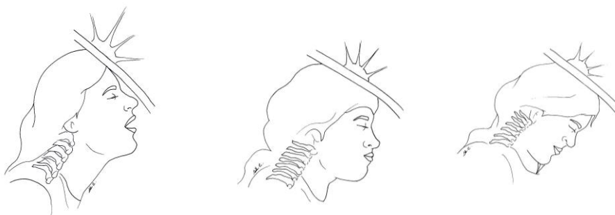
Figura 7 – Colisão da cabeça com o para-brisa dianteiro do veículo
