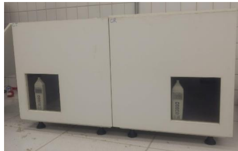
Figura 4: Caixa transmissora e receptora para ensaio acústico. Fonte: Autores (2017)
