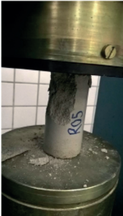
Figura 5 – Ensaio de resistência à compressão do corpo de prova cilíndrico.
