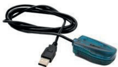
Figura 4 - Datalogger - LOGBOX- IP NÓVUS e Interface Infra vermelho com Usb- Modelo IR- LINK3 USB (Autores, 2017).
