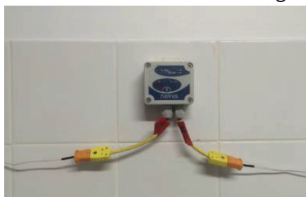
Figura 4 - Datalogger - LOGBOX- IP NÓVUS e Interface Infra vermelho com Usb- Modelo IR- LINK3 USB (Autores, 2017).
