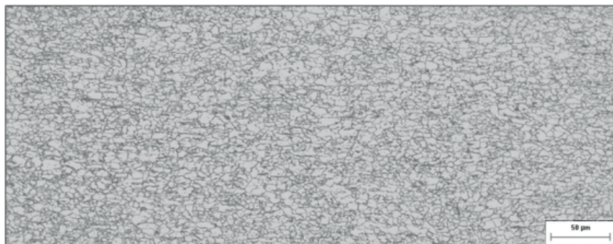
Figura 3 – Micrografia Recozida em Forno Contínuo com Aumento de 200x (FONTE: Elaborado Pelo Autor)
