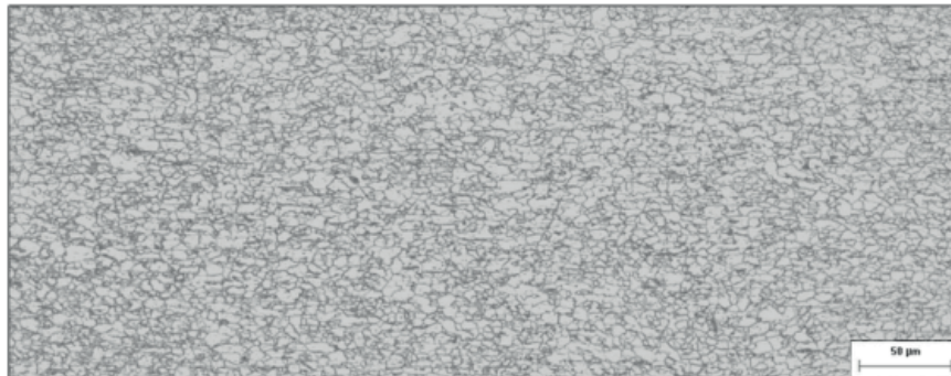
FIGURA 2 – Micrografia de Material Recozido em Forno Caixa Com Aumento de 200x (FONTE: Elaborado Pelo Autor)
