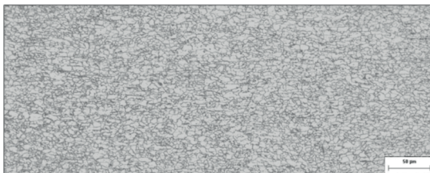
FIGURA 1 – Micrografia de Material Laminado no LTF com Aumento de 200x (FONTE: Elaborado Pelo Autor)
