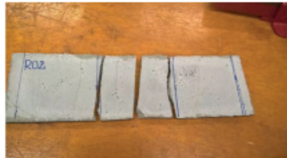
Figura 8 – corpo de prova de referência após rompimento.
