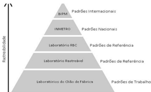
Figura 9 - Estrutura hierárquica do sistema metrológico.
