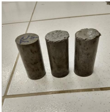
Figura 3: Corpos de prova do concreto TC6, com adição de 30% cinza volante.
